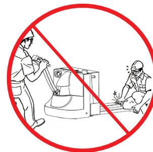
No colocar ninguna parte de tu cuerpo en ninguna parte en movimiento de la carretilla para evitar ser apretada.
